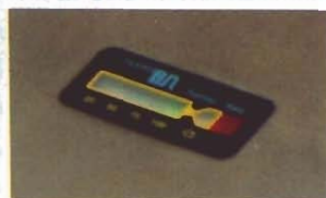
Display di verifica carica accumulatori Leds that show the batteries charge
