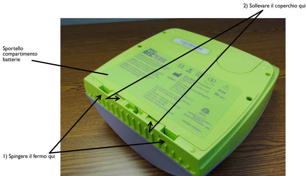
Figura 7: Togliere lo sportello del compartimento batterie
