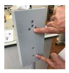
1. Il posizionamento della placca del nuovo dispenser avverrà tramite la bussola in basso e il foro come indicato in figura
